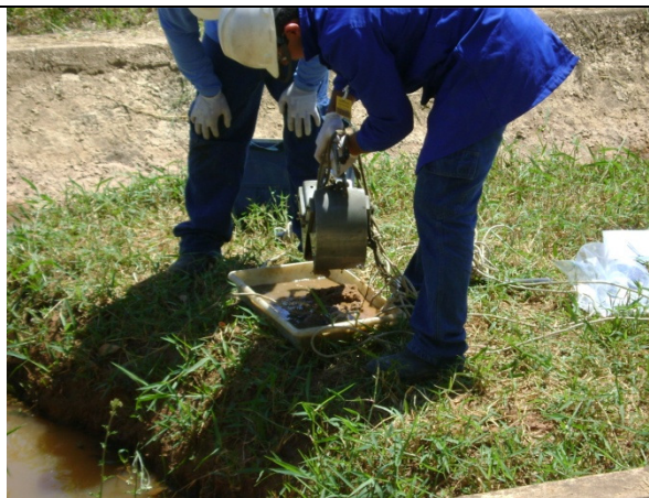
Foto V.4.2.5-7: Draga do tipo Van Veen utilizada para coleta de amostras de bentos – Ponto P3
