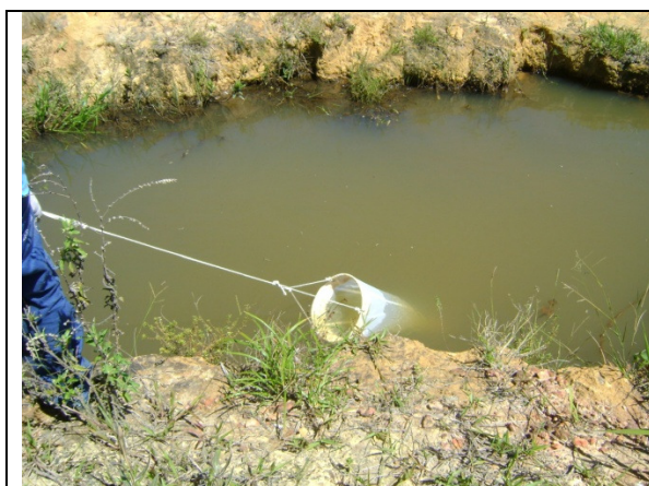
Foto V.4.2.5-5 – Rede para coleta de fitoplâncton de 20 \mu m – Ponto P2
